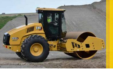
Le modèle GC CS12 Cat<sup>®</sup> comporte un cylindre lisse et convient parfaitement aux applications sur sols granulaires avec un kit de bandage pour pieds dameurs en option pour les applications sur sols cohésifs.
