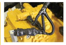
Terminais elétricos Silicone é aplicado nos terminais elétricos, incluindo: terminais do relé principal, terminais do alternador, terminal da chave geral, partida do motor, cabos de aterramento do motor e cabos de bateria a fim de maximizar a vida útil dos componentes elétricos.
