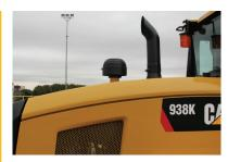
Pré-purificadores de ar Oferece excelente limpeza do ar de entrada, ejetando as partículas corrosivas antes de se fixarem no filtro de ar.
