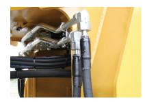
Conexões hidráulicas Conexões hidráulicas protegidas por tubos termo retráteis para inibir a corrosão.
