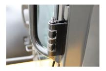
Pontos de lubrificação Pontos de lubrificação são adicionados às dobradiças das portas.
