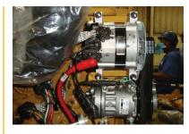
**Alternador** Alternador de 150A sem escova para aplicações severas, com filtro extra para maior resistência às substâncias corrosivas.
