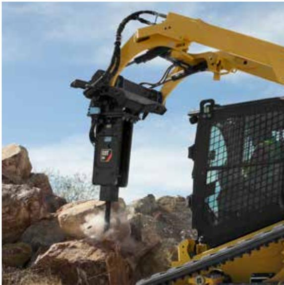
Los Martillos B Cat<sup>®</sup> son adecuados para una amplia gama de aplicaciones de demolición general y construcción, como la ruptura de terrenos congelados para reparaciones de servicios públicos, aceras y caminos de hormigón, pavimento, calles, albañilería, preparación de sitios y paisajismo. Cada modelo de Martillo B está disponible en configuraciones silenciadas o no silenciadas. La versión silenciada se identifica con el sufijo 's', por ejemplo B6s.
