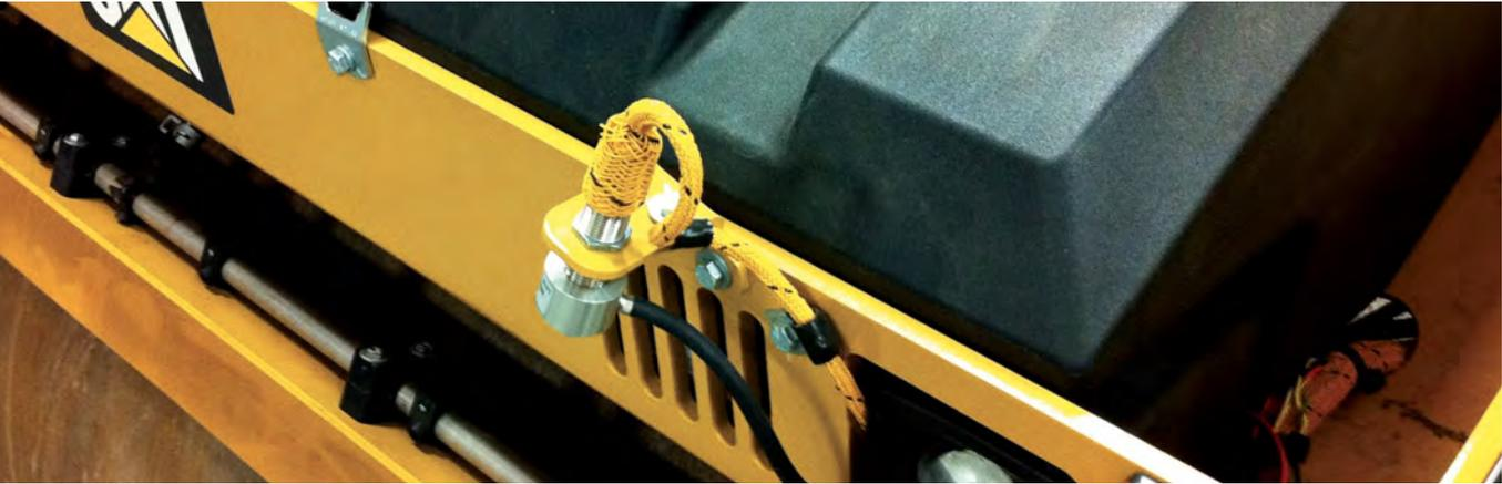
*Infrarotsensoren senden Temperaturdaten an die Anzeige im Führerhaus.*
