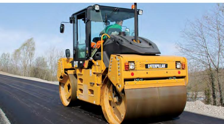
Üblicherweise werden für die Anfangsverdichtung Tandemvibrationswalzen eingesetzt.
