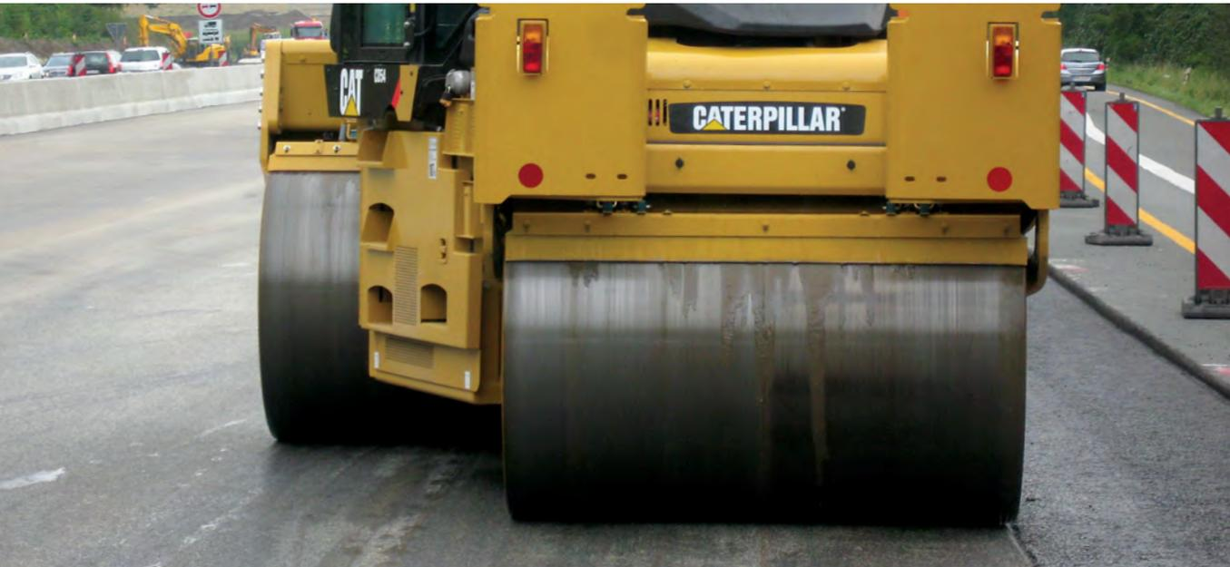
Durch Bandagenversatz ist es einfacher, eine breite Abdeckung zu realisieren und dünne Einbaubahnen, die Wärme rasch abgeben, schneller zu verdichten.
