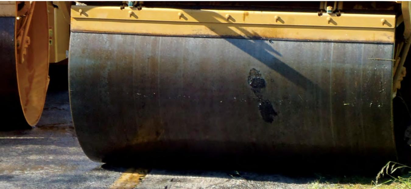
*Splittmastixasphalt mit polymermodifiziertem Bitumen klebt an der Stahlbandage fest.*
