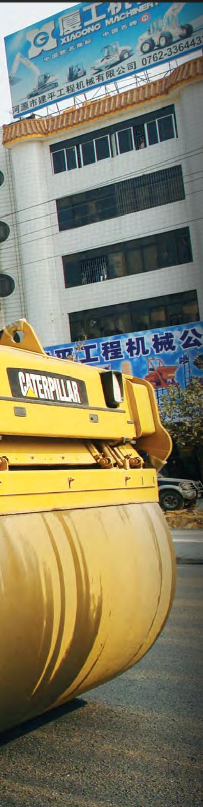
Ein Walzkonzept besteht aus einer Abfolge von Bewegungen, die von einer Walze oder von mehreren Walzen auf einer frisch verlegten, unverdichteten Asphaltmischgutschicht ausgeführt werden. Das Walzschema soll in gleichbleibender Weise wiederholt werden, damit in der Asphaltmischgutschicht eine konstante Dichte erzeugt wird.
