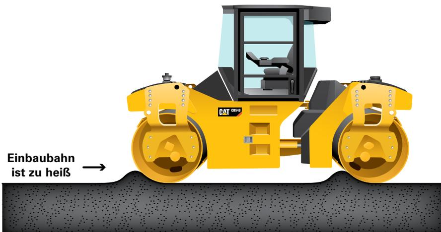
Meist, wenn nicht gar immer, sollte die geforderte Dichte der Schicht innerhalb der Zeit erreicht werden, in der die Einbaubahn auf ca. 90°C abkühlt. Bei dieser Temperatur wird der Asphalt so fest, dass ein weiteres Bewegen der Gesteinskörner nicht mehr möglich ist. Sie können dann zwar noch Marken und Spuren in der Oberfläche der Einbaubahn ausbügeln, aber eine Erhöhung der Dichte ist unwahrscheinlich. Wenn sich die Einbaubahn abgekühlt hat, bevor die geforderte Dichte erreicht wurde:
