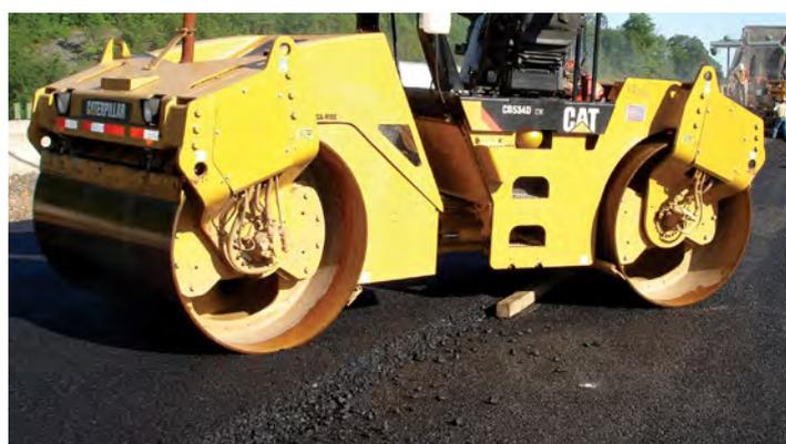
*Die Walze parkt zum Auffüllen des Wasservorrats auf dem Standstreifen, um ein Eindringen der Fahrbahn zu vermeiden. Sehen Sie ggf. einen Weg vor, um der Walze das Herunterfahren von einer Einbaubahn mit nicht begrenzter Kante zu ermöglichen.*
