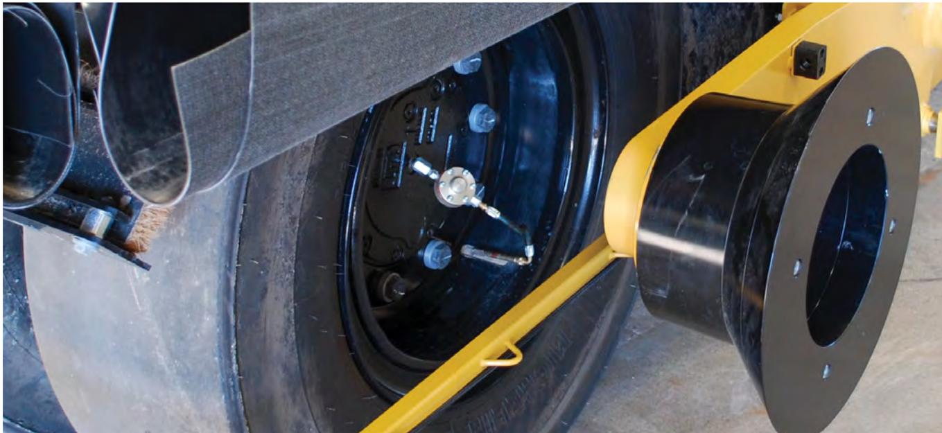
Mit der Option „Air-on-the-run“ ist es leichter, den Reifenfülldruck anzupassen.
