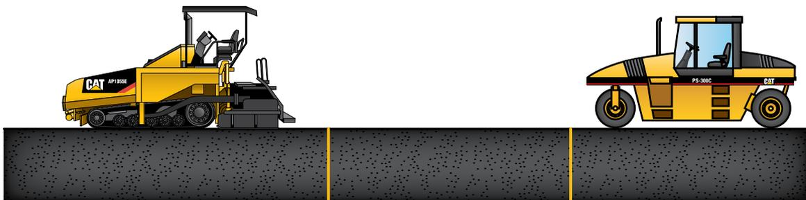
*Zwischenverdichtung kurz nach der Anfangsphase.*
