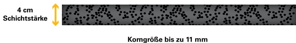
Bei einem Verhältnis von Schichtdicke zu Korngröße, das kleiner als 3:1 ist, gestaltet sich der Verdichtungsprozess sehr viel schwieriger. Wenn sich nämlich Bruchsteine in der Schicht befinden, dann ist es wahrscheinlich, dass diese nicht unbeschädigt in eine Ausrichtung gelangen, die einer dichten Packung entspricht. Der Walzenfahrer wird vermutlich ein Springen der Bandage oder
