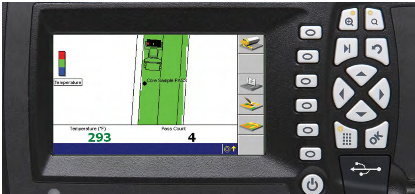
A nova tecnologia ajuda os operadores a manter a consistência dos padrões de rolagem.
