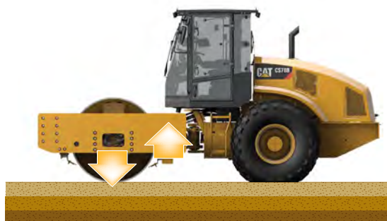
Résonance agissant contre l'énergie de compactage
