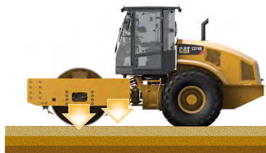
La résonance agissant avec l'énergie de compactage est la convergence harmonique
