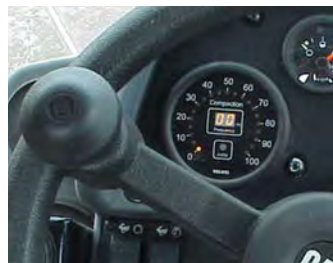
mesure du compactage intégrée à la machine
