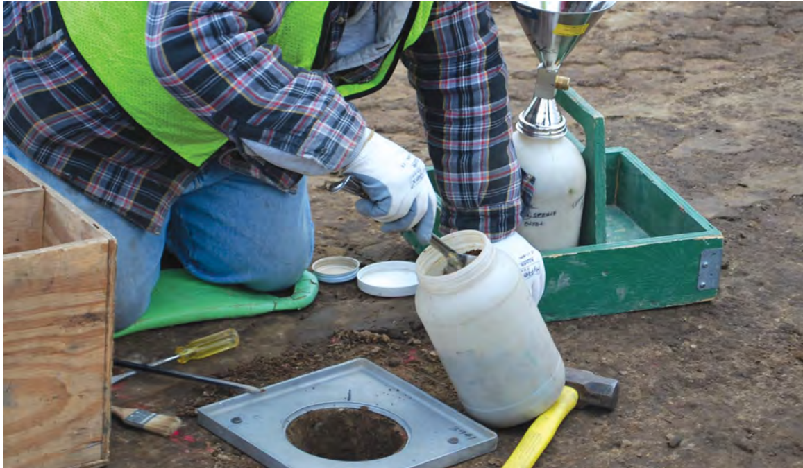
La méthode du cône de sable a prouvé son efficacité.
