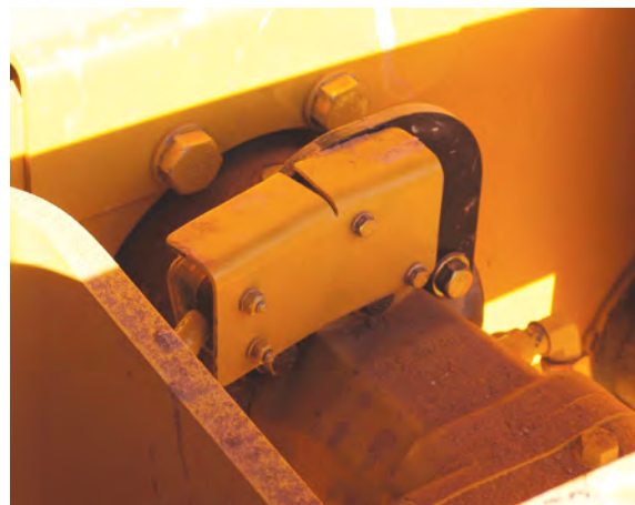
Les accéléromètres mesurent la réaction du sol lorsqu'il est heurté par le cylindre vibrant.
