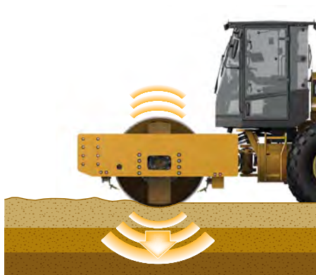
L'énergie vibratoire est transmise au sol par le cylindre vibrant.
