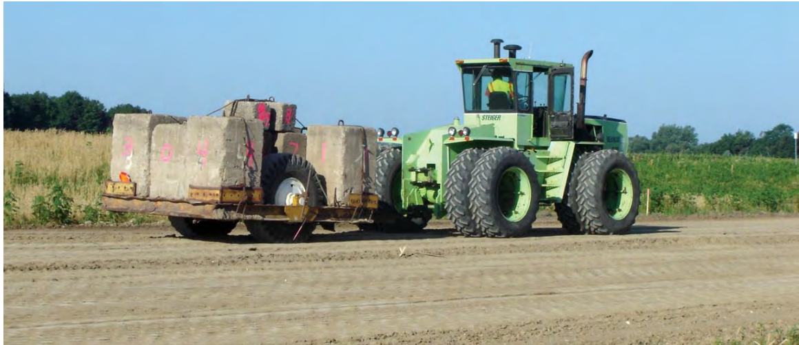
Un compacteur d'essai
