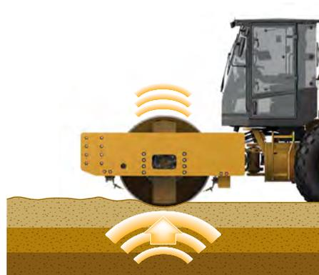
*Материал вибрирует в ответ, что обнаруживается и измеряется акселерометром*
