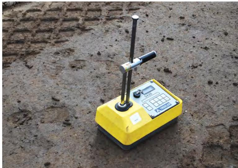
*Радиометрический плотномер Troxler*
