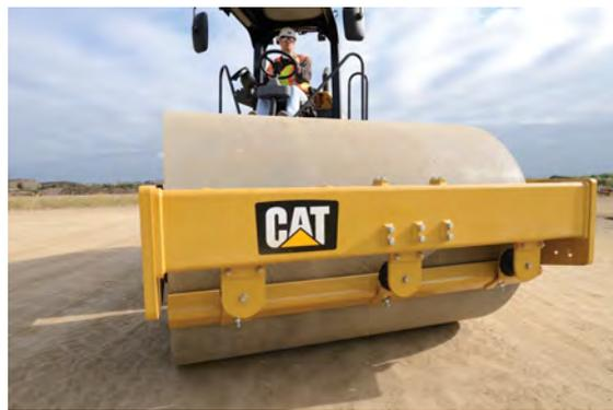
**Рабочая скорость:** в целом, скорость движения играет важную роль в производительности строительных работ: чем быстрее машина, тем быстрее выполняется работа. Однако при использовании виброкатков, в отличие от всех других типов машин, производительность в большинстве случаев повышается при снижении скорости хода. Существует оптимальная, с экономической точки зрения, скорость, позволяющая катку обеспечить требуемое уплотнение.
