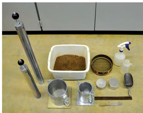
*Комплект инструментов для лабораторных испытаний по Проктору*
