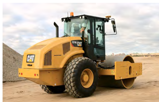
I sistemi di misurazione della compattazione integrati nelle macchine forniscono una previsione o un'indicazione circa la rigidità del suolo.
