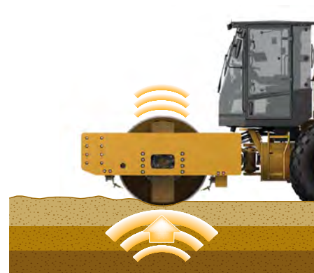
In risposta a tale sollecitazione, il materiale entra in uno stato di vibrazione che viene rilevato dall'accelerometro.
