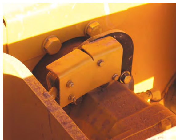
Gli accelerometri misurano la reazione del suolo quando viene colpito dal tamburo vibrante.
