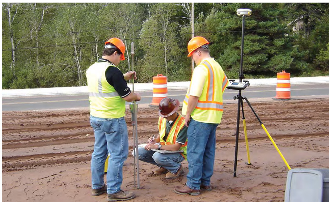
Un penetrometro a cono dinamico in uso.
