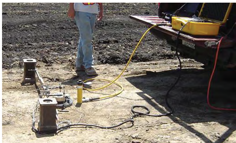
Preparazione di una prova di carico su piastra
