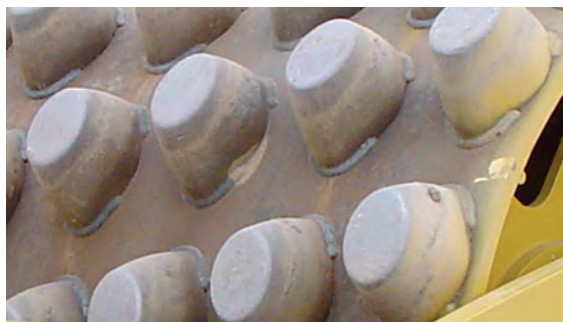
Gli artigli ovali sono particolarmente adatti per suoli coesivi e strati più spessi.
