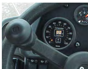
Misurazione della compattazione integrata nella macchina
