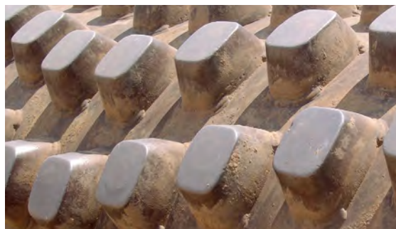
Gli artigli quadrati sono ideali per suoli semi-coesivi e strati più sottili.
