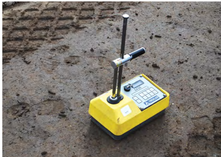
Una sonda Troxler o densimetro nucleare
