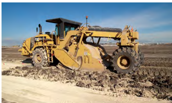
La stabilizzazione migliora le qualità ingegneristiche dei suoli.
