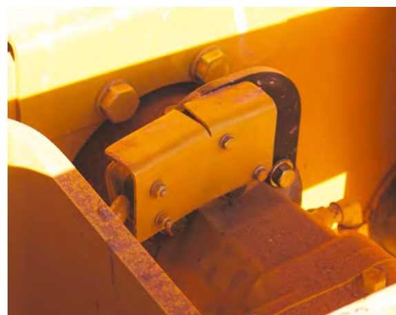
Los acelerómetros miden la reacción del suelo al ser golpeado por un tambor vibratorio.
