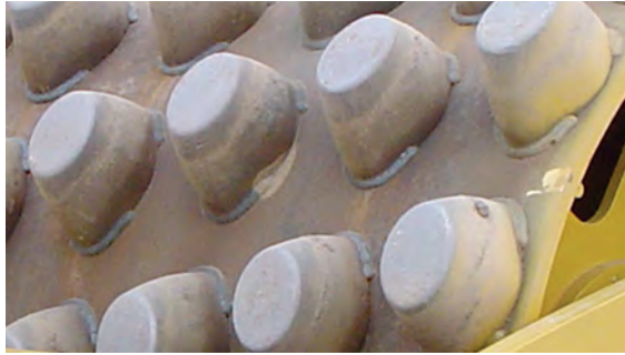
Las puntas ovaladas son buenas para los suelos cohesivos y capas más gruesas.
