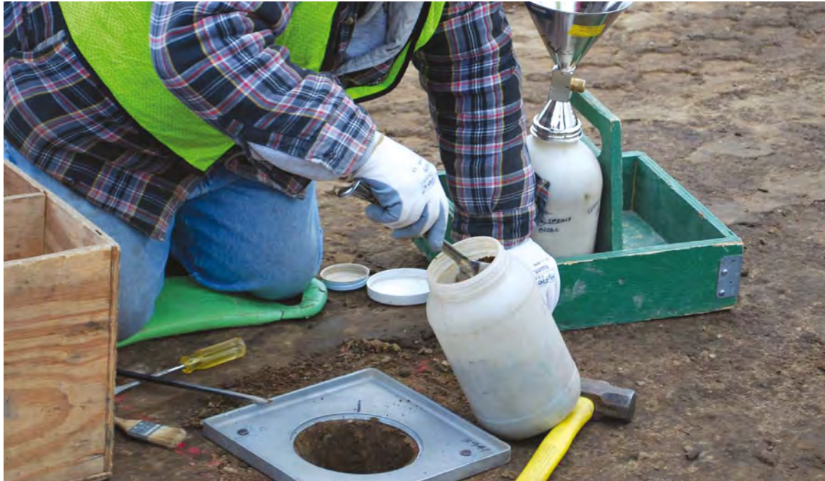
La precisión del método del cono de arena está comprobada.
