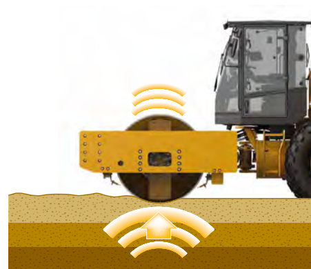
El material responde con vibraciones detectadas y medidas por el acelerómetro.
