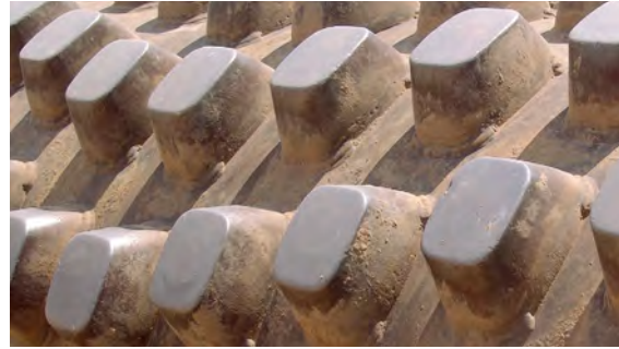
Las puntas cuadradas son mejores para suelos semi-cohesivos y capas más delgadas.
