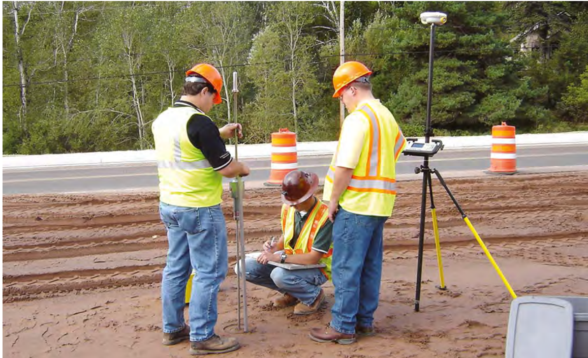
Utilizando el método del penetrómetro dinámico de cono
