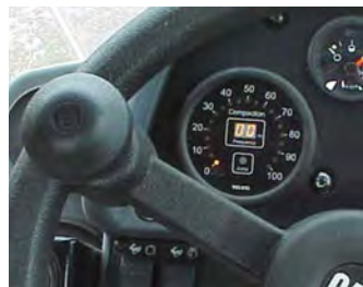
Medición integrada en la unidad compactadora
