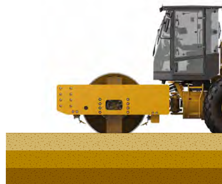
El desplazamiento en suelos rígidos requiere menos energía.
