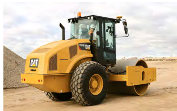
Los sistemas integrados en las unidades compactadoras predicen o indican la rigidez del suelo.
