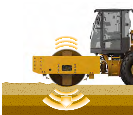
Tambor vibratorio impartiendo energía vibratoria en el suelo.
