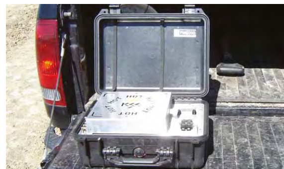
Horno portátil para medir la humedad en el suelo
