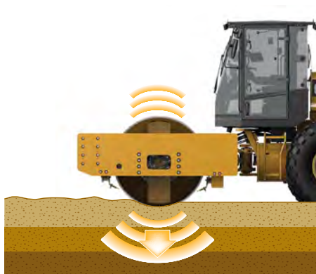
振动能量通过振动轮传到土壤。
