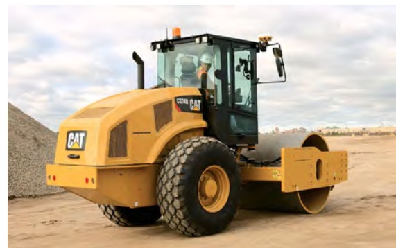
机器集成式压实测量可预测或说明土壤硬度。
