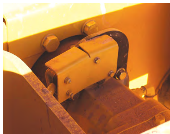
加速计测量土壤对于振动轮敲击的反应。
