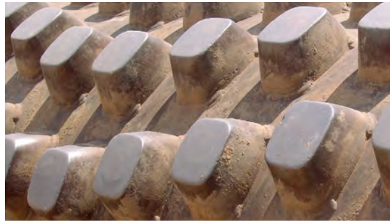
方形凸块最适用于半粘性土壤和较薄摊铺层。
