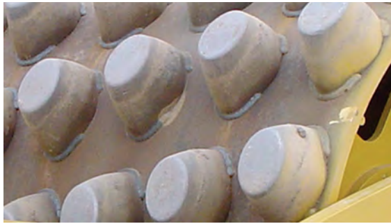
椭圆形凸块适用于粘性土壤和较厚摊铺层。
