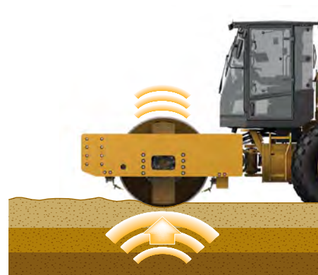
土壤中的物质因此产生振动，加速计会监测并记录下来该振动。
