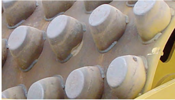
Ovale StampffüÙe sind eine gute Wahl bei bindigen Böden und dickeren Schichten.
