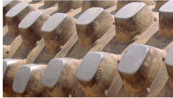
Quadratische StampffüÙe eignen sich am besten für halbbindige Böden und dünnere Lagen.
