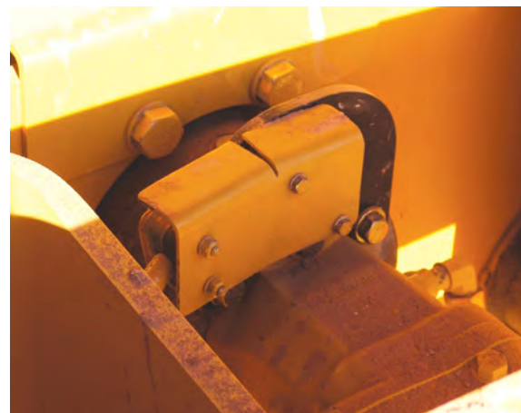
Beschleunigungssensoren erfassen die Reaktion der Bandage bei deren Kontakt mit dem Boden
