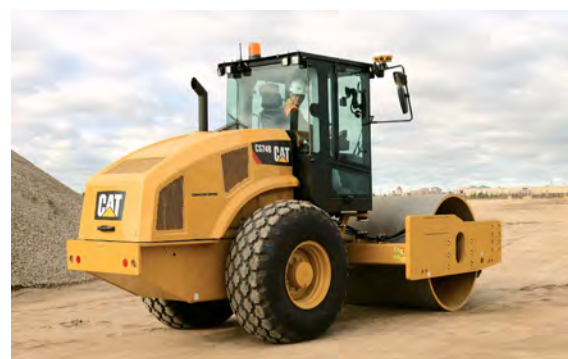
Mit dem Einsatz walzenintegrierter Meßsysteme läßt sich auf die Bodensteifigkeit schließen.
