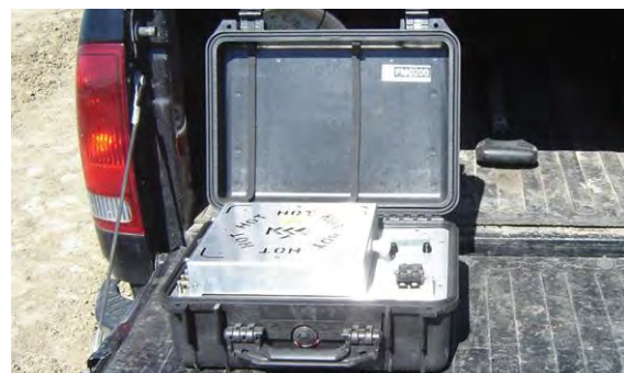
Tragbarer Ofen zur Bestimmung des Wassergehaltes des Bodens im Feld
