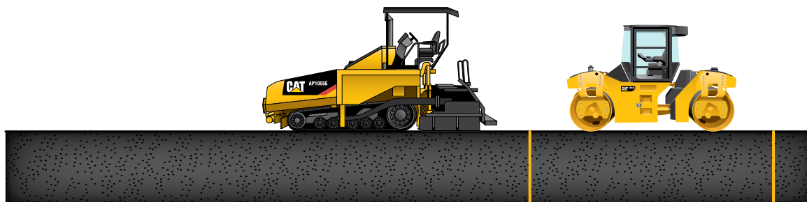
На начальном этапе каток работает близко к асфальтоукладчику.
