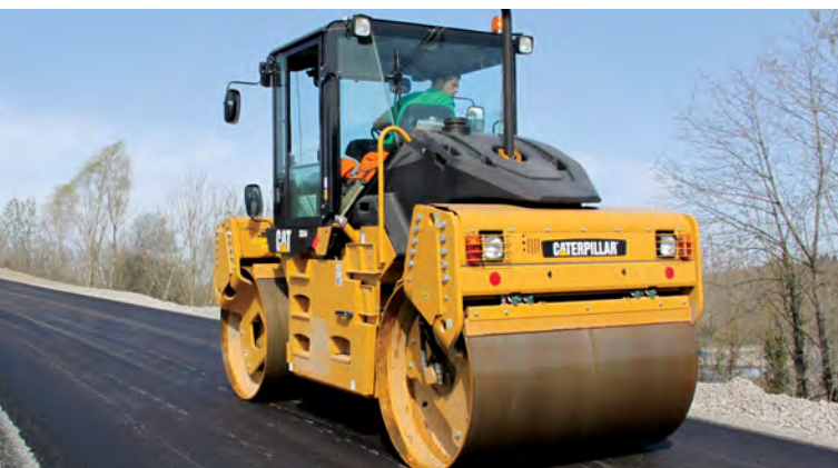
Начальное уплотнение обычно осуществляют вибрационными жестковальцовыми катками.
