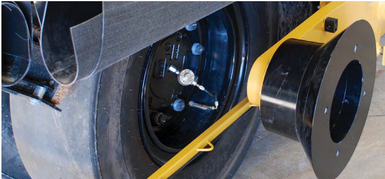
Оptionная система подкачки шин на ходу упрощает регулирование давления воздуха в шинах.
