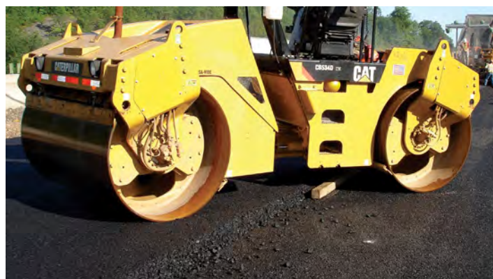
Слева каток, остановленный во время заправки водой на обочине, для того чтобы исключить образование вмятин на полосе движения. Справа применение при необходимости средств для съезда катка с полосы, край которой не имеет бокового упора.
