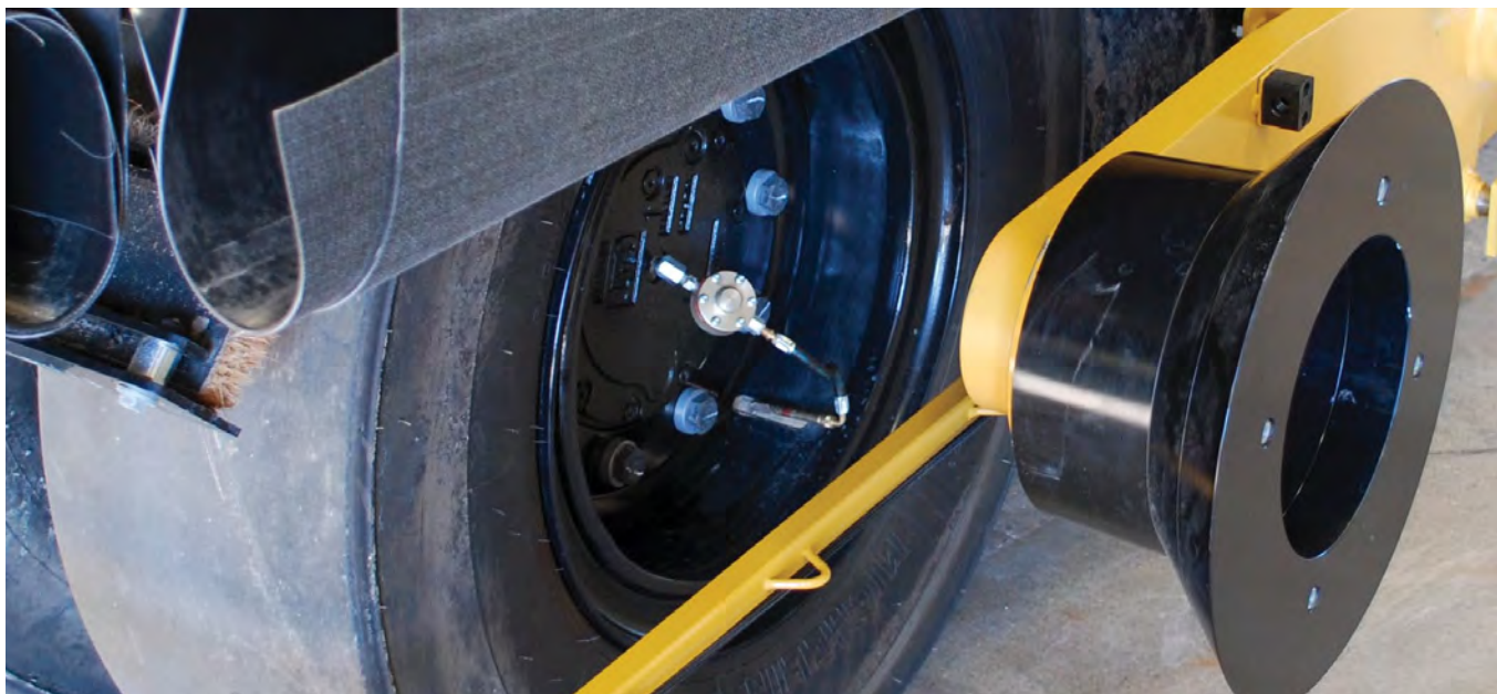
L'option air-on-the-run facilite l'ajustement de la pression de gonflage des pneus.
