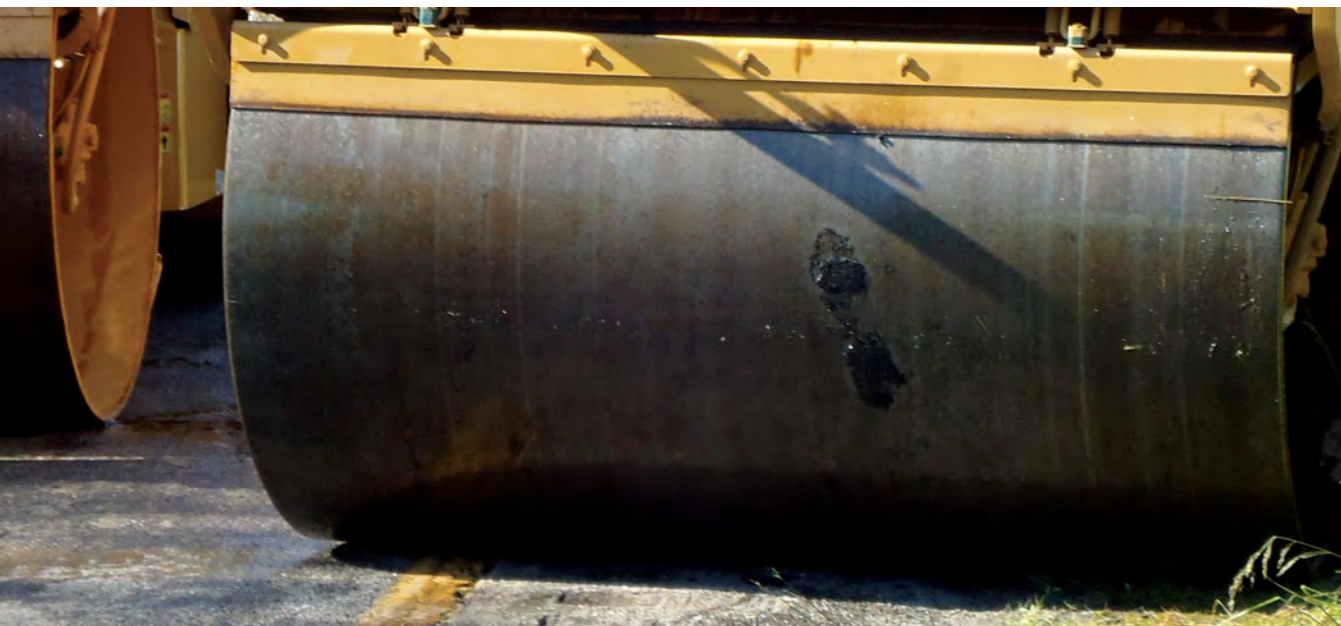
Collage d'un enrobé à matrice de pierre avec ciment bitumineux polymérisé sur un cylindre d'acier.
