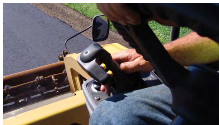
Les buses de pulvérisation fonctionnent correctement lorsque les consignes de maintenance sont respectées et que le circuit de pulvérisation utilise de l'eau propre.
