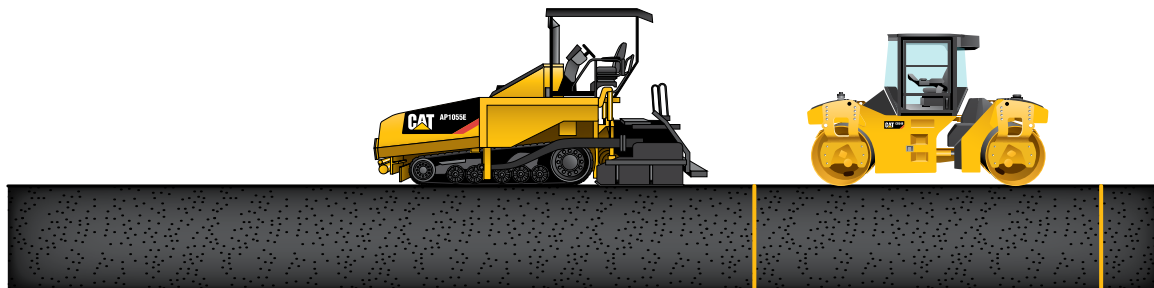
Le compacteur de phase initiale travaille à proximité du finisseur.
