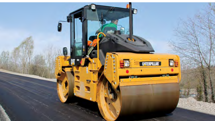
Des compacteurs tandem vibrants sont généralement utilisés pour le compactage initial.
