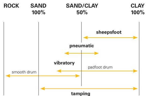
**OPERATING CHARACTERISTICS FOR SOIL COMPACTION EQUIPMENT**
