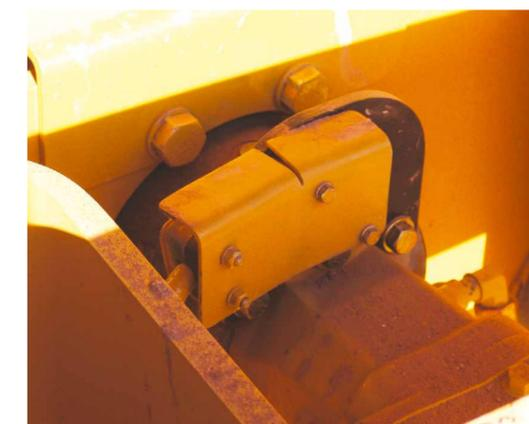
Os acelerômetros medem a reação do solo que é golpeado pelo rolo vibratório.
