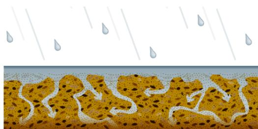
**Permeabilidade** é a facilidade com que a água flui através de um solo. Não é o mesmo que capilaridade, que é a capacidade de um solo em absorver a água. A textura, a gradação e o grau de compactação do solo influenciam a permeabilidade do solo. Permeabilidade é o parâmetro mais variável do solo, com valores que variam mais de
