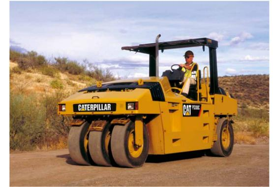
A compactação por manipulação é usada para se obter uma superfície bem vedada para ajudar o material a resistir aos efeitos da água e das condições climáticas.
