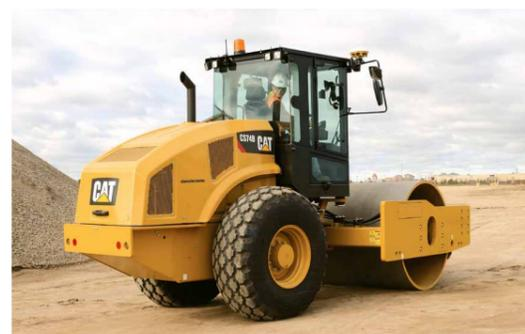
Os sistemas de medição da compactação integrados à máquina oferecem uma provisão ou um indício da dureza do solo.
