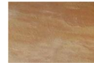
**Silte –** Os siltes são sedimentos finos não plásticos que, normalmente, são compactados com compactadores vibratórios de rolo de aço liso. Podem
