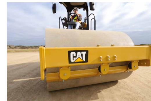
**Velocidade de Trabalho** – Em geral, as velocidades de deslocamento desempenham um papel importante na produtividade da construção. Quando mais rápida for a máquina, mais depressa a obra será terminada. No entanto, com os compactadores vibratórios, diferentemente de todos os outros tipos, a produtividade geralmente aumenta com a redução da velocidade de deslocamento. Há uma velocidade economicamente ideal que vai permitir ao compactador alcançar a compactação desejada.
