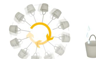
**força centrífuga =  $Mw^2r$**
