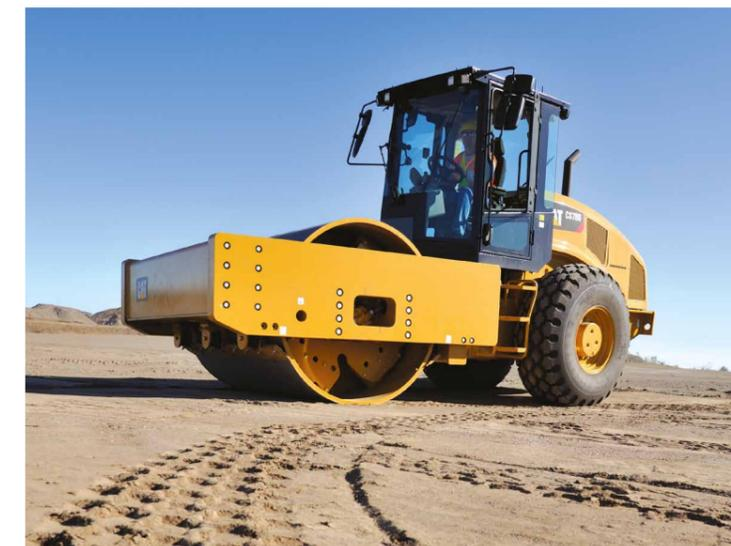
Com esse nível de dados e detalhes, a tecnologia de medição da compactação pode agora igualar-se à localização física em um canteiro de obra e pode ser configurada para mapear esses valores, inclusive a contagem de passadas, a direção do deslocamento da máquina e muitos outros ajustes da máquina.
