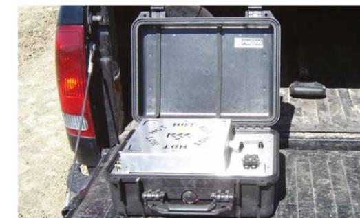
Um forno portátil da umidade do solo
