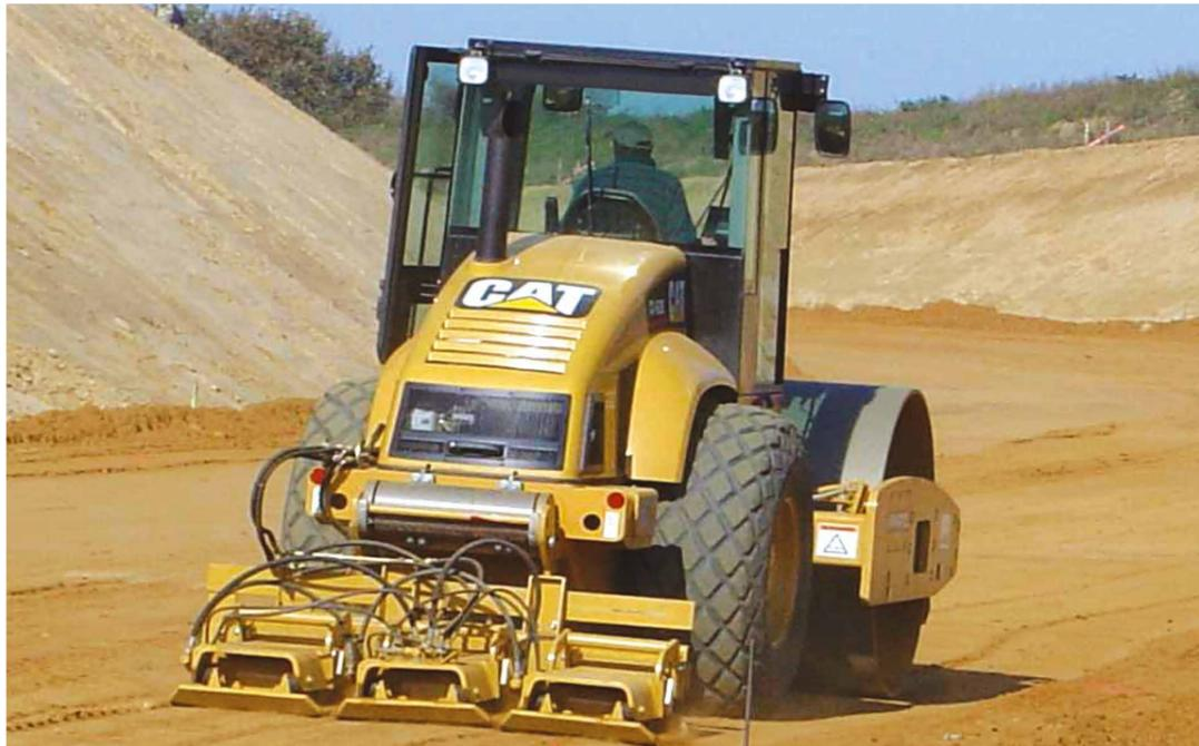
**Placas Vibratórias Traseiras** – Em material não coesivo, os compactadores vibratórios de solo com um único rolo podem ser equipados com placas vibratórias traseiras, que oferecem uma vedação da superfície que não pode ser obtida com o compactador de rolo simples. Isso permite que o operador considere o gradiente da compactação: o compactador vibratório com rolo simples consegue uma compactação mais profunda, e a placa vibratória compacta e veda a superfície.
