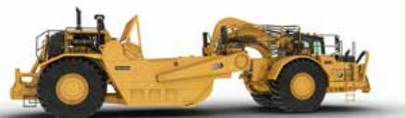
Décapeuse automotrice sur pneus
