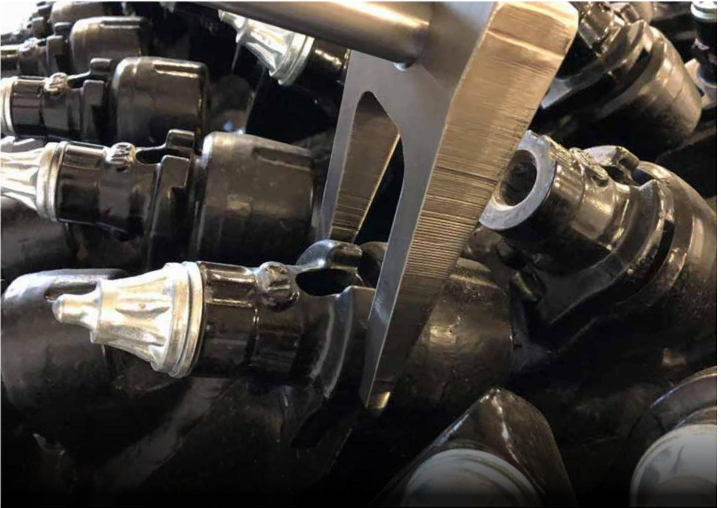
El mantenimiento de las puntas y los portaherramientas resulta esencial para obtener la máxima productividad y los rotores System K están diseñados para simplificar el mantenimiento y permitirle retomar su trabajo con mayor rapidez.
