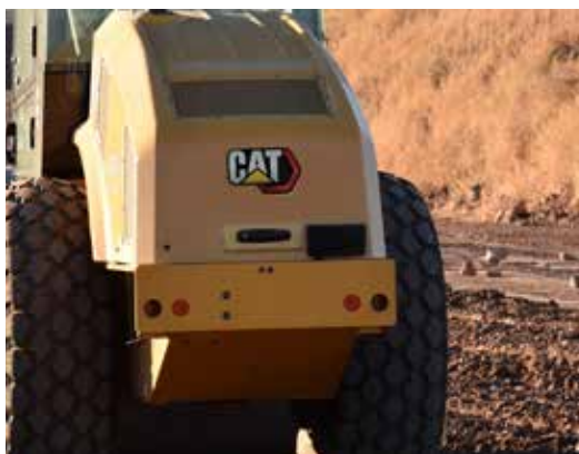
SENSORE RADAR MONTATO SUL VANO MOTORE POSTERIORE.
