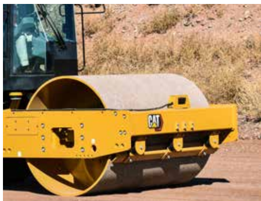
SENSORE RADAR MONTATO SUL PARAURTI ANTERIORE.
