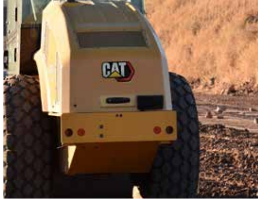
ARKA MOTOR BÖLMESİNE TAKILI RADAR SENSÖRÜ.
