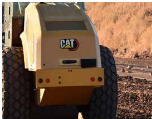
CZUJNIK RADAROWY ZAMOCOWANY DO TYLNEJ OBUDOWY SILNIKA.
