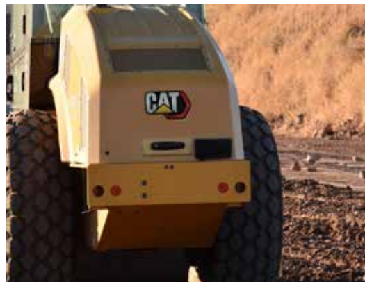
RADARSENSOR AN DER HINTEREN MOTORRAUMVERKLEIDUNG
