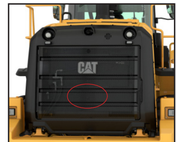
Individuazione ostacoli durante la retromarcia (radar)
