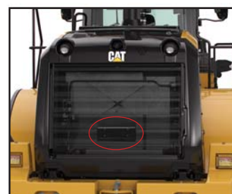
Individuazione ostacoli durante la retromarcia (radar)
