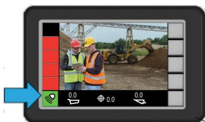
Détection d'objet arrière (radar)
