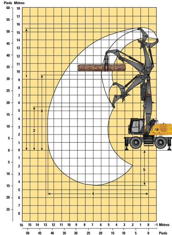
Hauteur maximale à niveau de la grue : 11 000 mm (36'1")
