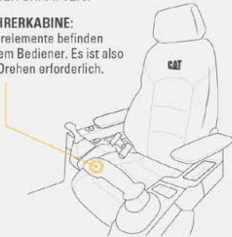
**ALTE FAHRERKABINE:** mehr als 2000 den Rücken belastende Drehungen pro Jahr, um die Steuerelemente im hinteren Bereich der Fahrerkabine zu erreichen.
