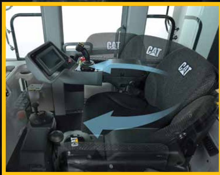
Il sedile ruota di 180 gradi per un maggiore comfort e una migliore visibilità
