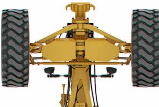
O cilindro de direção do eixo frontal foi projetado para aumentar a durabilidade, e as mangueiras hidráulicas foram direcionadas para melhorar a confiabilidade.
