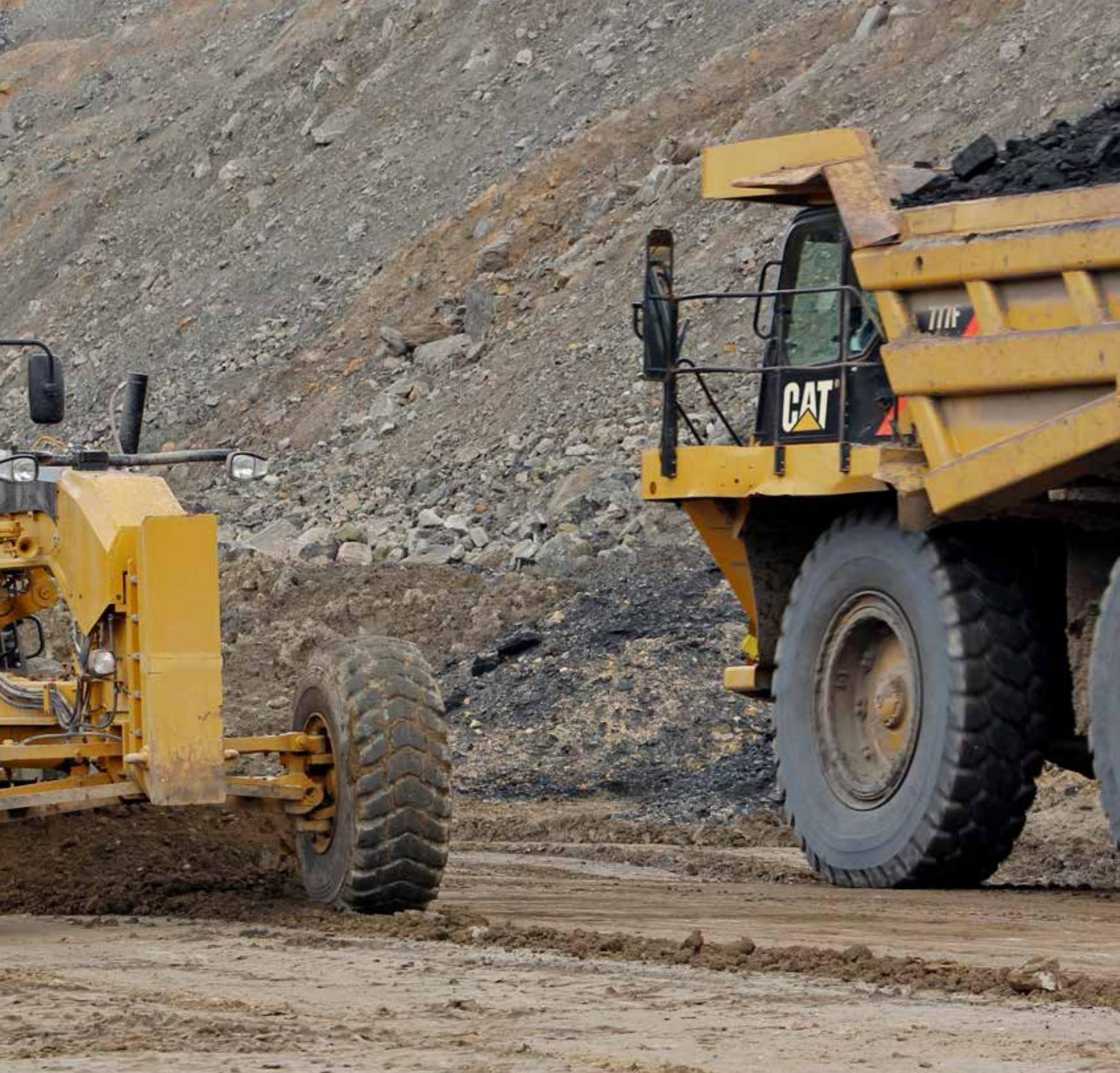
**Com potência adicional, armação da lâmina mais larga e a possibilidade de utilizar um ângulo de lâmina mais agressivo, a 18 melhora a eficiência operacional, aumentando a cobertura e reduzindo o número de passadas necessárias para nivelar as estradas de transporte.**
