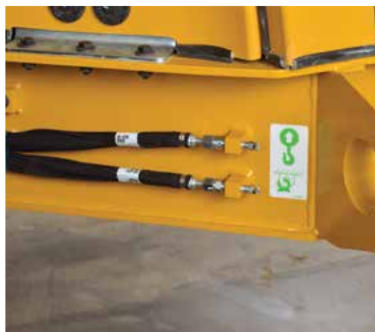
Conexiones de engrase remotas agrupadas
