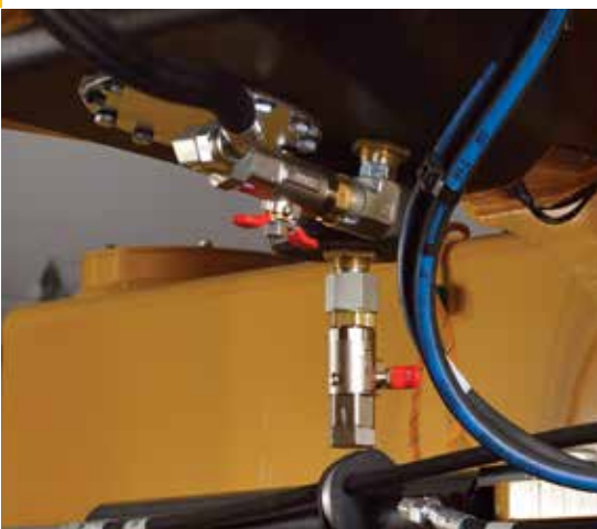
Válvulas de drenaje agrupadas
