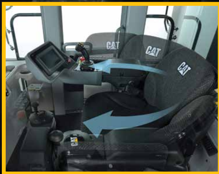
El asiento gira 180 grados para una mayor comodidad y visibilidad
