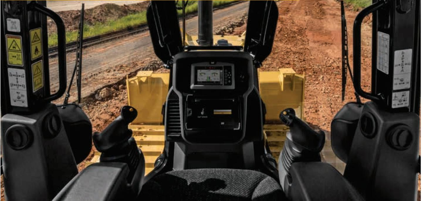
La cabine spacieuse et silencieuse offre un confort tout au long de la journée grâce à ses grandes ouvertures de porte et à son siège à suspension pneumatique. Les commandes par manipulateur ergonomiques montées sur le siège isolent les vibrations. L'excellente visibilité sur la lame, les bordures de trottoirs et les espaces confinés vous aident à travailler avec plus de précision.
