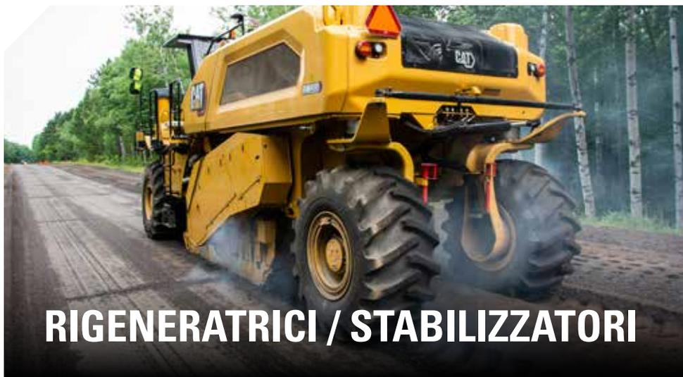
Le rigeneratrici/stabilizzatrici di suolo Cat polverizzano lo strato di asfalto e lo miscelano con la base sottostante oppure miscelano additivi e aggregati nel suolo per stabilizzare manti stradali deteriorati o suolo per una base solida.
