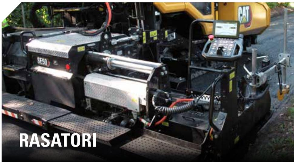
I rasatori Cat assicurano lunga durata, facile regolazione e semplice manutenzione. La sostituzione semplice dell'elemento scaldante e i telai dei rasatori lavorati facilitano la manutenzione rapida e riducono i costi di esercizio.
