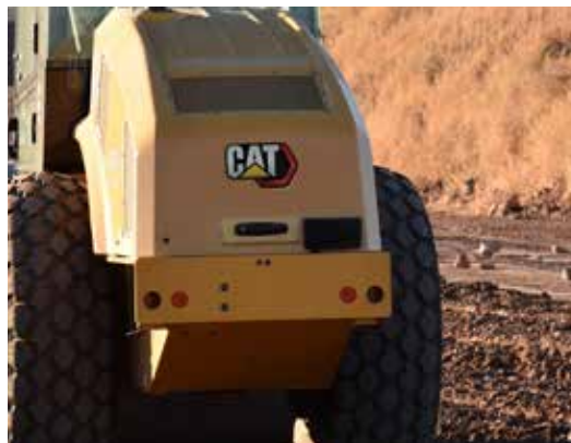
CAPTEUR RADAR MONTÉ SUR LA CAPOTAGE MOTEUR ARRIÈRE.
