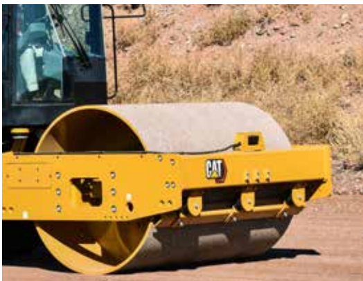
CAPTEUR RADAR MONTÉ SUR LA PARE-CHOCS AVANT.
