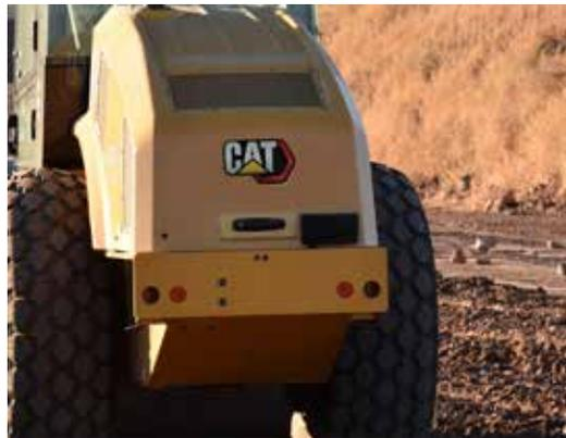
SENSOR DE RADAR MONTADO EN EL RECINTO DEL MOTOR TRASERO.
