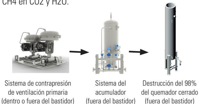
Figura 1: Sistema de quemador cerrado
