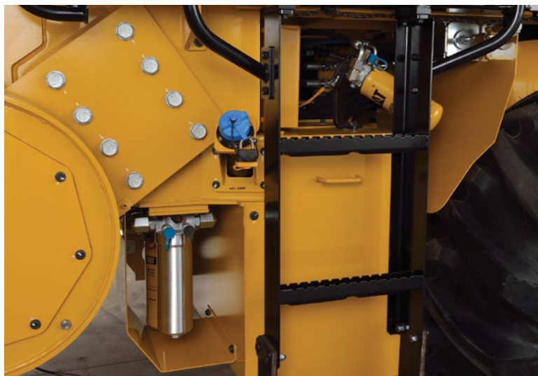
SINISTRA: Facile accesso ai filtri idraulici e alla porta di riempimento DEF
