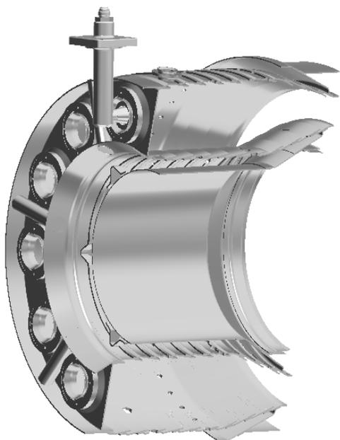
Гильза и топливная форсунка стандартной камеры сгорания
