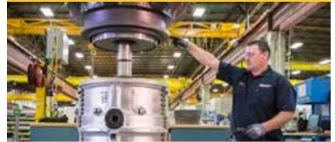
原涡轮机拆解和检查
