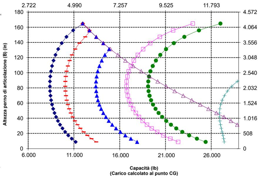
**NOTA:** i carichi statici di ribaltamento e i pesi operativi fanno riferimento a una pala configurata con pneumatici L3 MAXAM MS302, climatizzatore, aria condizionata, controllo dell'assetto, protezione trasmissione, serbatoi dei liquidi e dei combustibili pieni, liquido di raffreddamento, lubrificanti e operatore.
