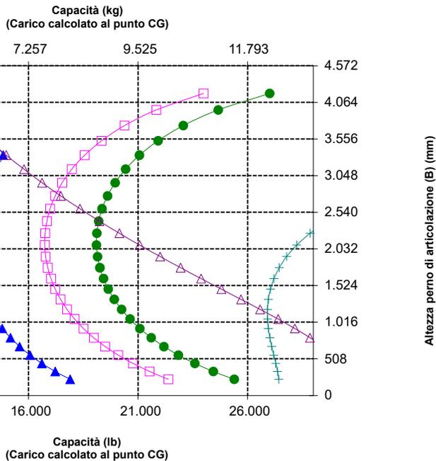
NOTA: i carichi statici di ribaltamento e i pesi operativi fanno riferimento a una pala configurata con pneumatici L3 MAXAM MS302, climatizzatore, aria condizionata, controllo dell'assetto, protezione trasmissione, serbatoi dei liquidi e del combustibile pieni, liquido di raffreddamento, lubrificanti e operatore.
