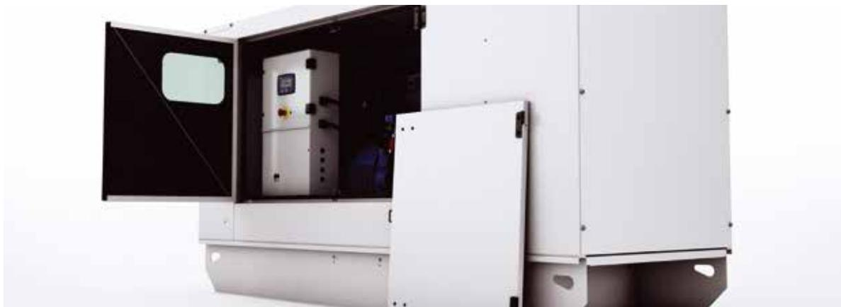
罩壳侧边安装侧铰接门，可轻松操作所有必要的组件，方便安装和维护工作。门采用拼装铰链，可在打开90°时拆下，安装空间有限时，使维修操作更便捷。
