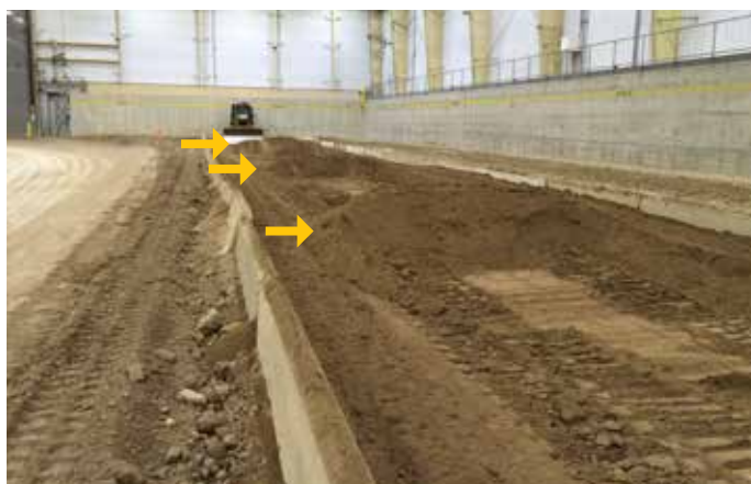
De machinisten begonnen op een zandstrook met drie hopen zand die moesten worden verspreid, om vrachtwagenladingen te simuleren.
