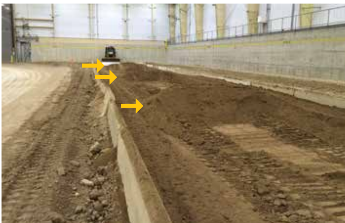
Die Fahrer begannen mit einem Sandstreifen mit drei Haufen Sand, als Simulation der Situation, in der von einem Kipper abgeladener Sand verteilt werden soll.
