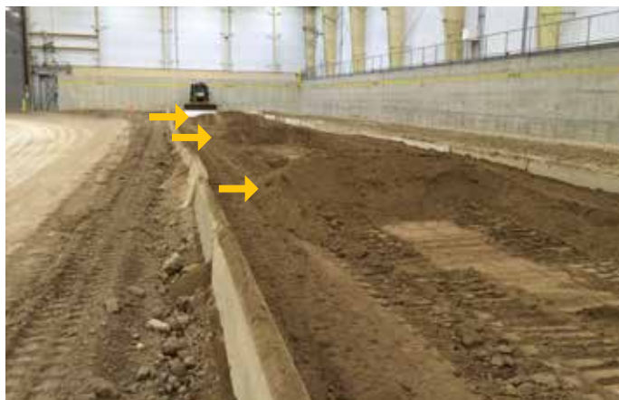
Gli operatori hanno iniziato su una striscia di sabbia con tre cumuli di sabbia da stendere, simulando l'impiego di un dumper.
