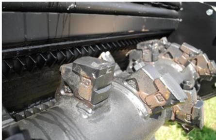
Einzelraubensicherung mit Hartmetallzähnen
