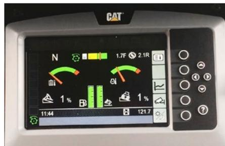
Balkenanzeige für Trommelrichtung und -drehzahl
