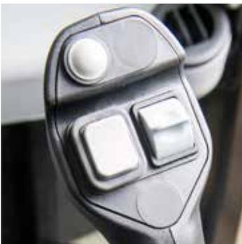
*Circuit hydraulique auxiliaire à haut débit*
