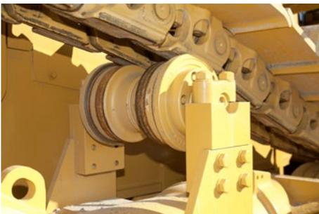
Das Delta-Laufwerk und die Aufhängung erhöhen gemeinsam die Traktion und verschaffen dem Fahrer mehr Fahrkomfort. Dies steigert letztlich die Produktivität und die Lebensdauer der Komponenten. Sie überträgt an den Arbeitsgeräten induzierte Stoßbelastungen auf den Hauptrahmen, sodass die Seitenantriebe, Achsen und Lenkungskomponenten vor hohen Belastungen geschützt werden, wie sie beim Einsatz großer Kettendozer auftreten.
