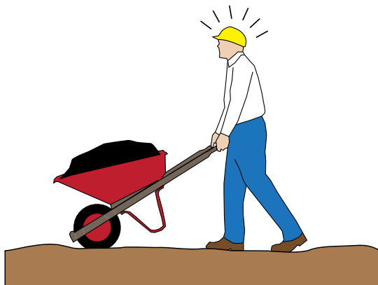
Das Schubkarrenrad sinkt in den lockeren Boden ein. Das Schieben erfordert einen größeren Kraftaufwand.
