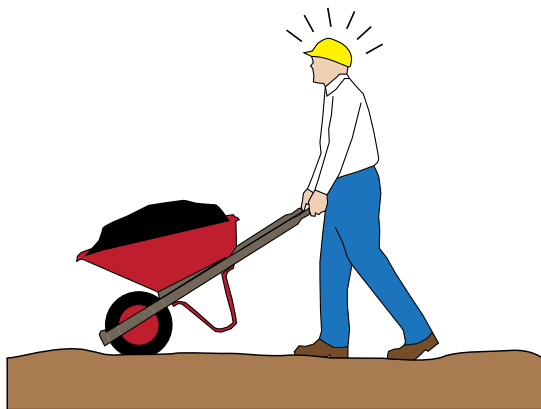
手推车轮在松散土壤上会下陷，需用更多力量才能推动。
