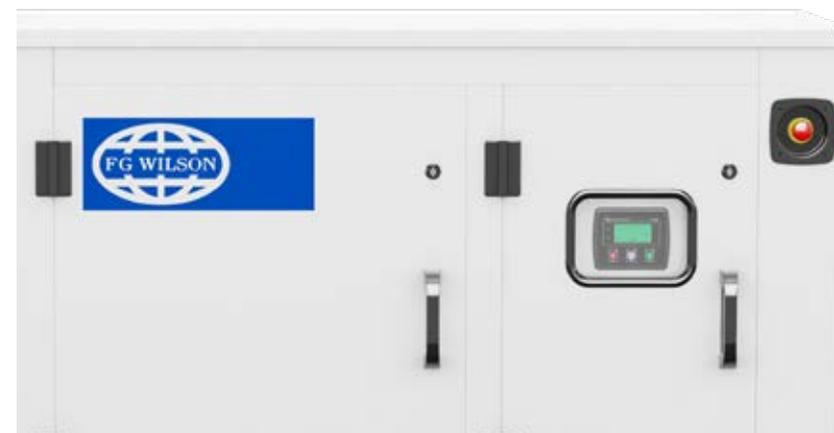
Le bouton poussoir d'arrêt d'urgence est commodément disposé côte à côte avec le tableau de commande, à l'extérieur du capotage. Les conditions de fonctionnement du groupe électrogène peuvent facilement être contrôlées par la grande vitre d'observation. Pour une sécurité accrue, toutes les portes sont munies de serrures verrouillables.
