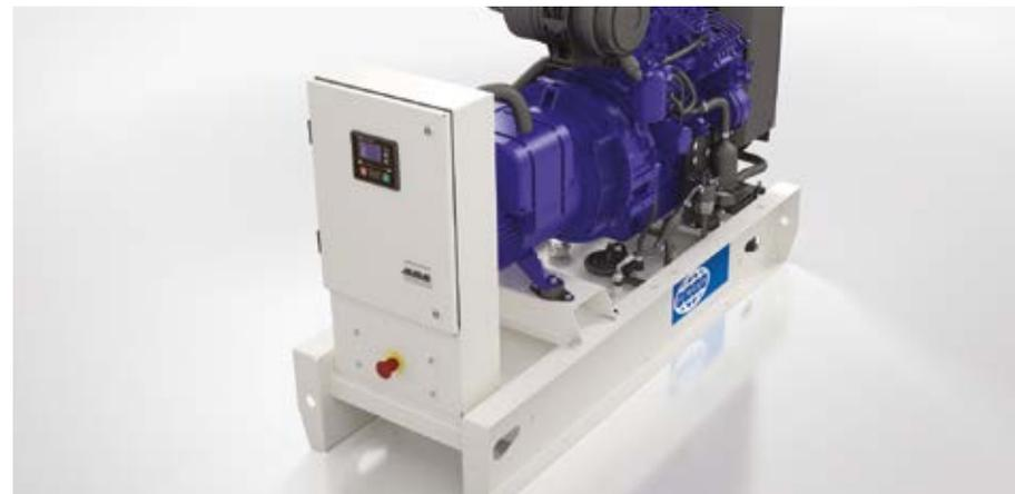
Des composants électriques robustes, tels que des relais, des régulateurs automatiques de tension et des disjoncteurs, sont regroupés et centralisés dans le panneau de commande. Ils sont facilement accessibles par une porte battante latérale verrouillable. Le passage des câbles se fait directement sous le tableau de commande pour simplifier l'installation.
