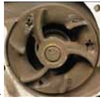
Cat® DEAC™ protegió esta bomba de agua y obtuvo un puntaje de nueve en un máximo de diez en la prueba.
