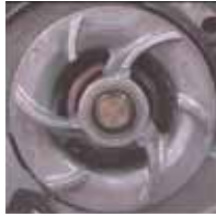
Cat® DEAC™ protegió esta bomba de agua y obtuvo un puntaje de nueve en un máximo de diez en la prueba.
