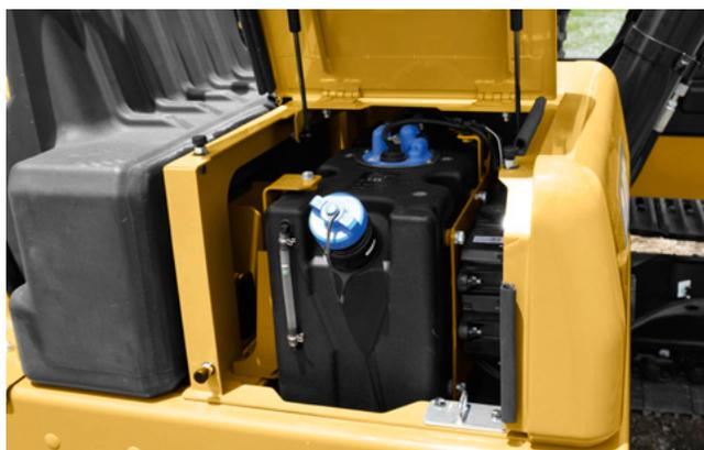
ディーゼル排気流体選択触媒還元 (DEF SCR) システムは、日本国土交通省オフロード法 2014 年排出ガス要件 (Tier 4 Final) に適合しています。尿素水タンクは機械右前部の地上からアクセス可能な場所にレイアウトしており、安全かつ容易に補給する事ができます。尿水素タンクに装備されているゲージを確認するだけです。
