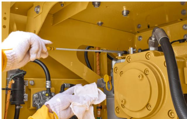
日常点検箇所は 100% 地上からアクセスする事ができ、メンテナンスをより迅速かつ安全、容易に実施できます。日常点検箇所には、エンジンオイルレベル確認、ウォーターセパレータ水抜き、燃料タンク内の水・異物排出、冷却システムのクーラントレベル確認などが含まれます。
