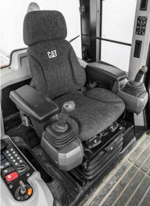
Die verbesserte Kabine bietet dem Fahrer zusätzlichen Komfort, wie beispielsweise einstellbare Armlehnen und Steuerungen, eine verbesserte Klimaanlage und einen als Sonderausstattung erhältlichen beheizbaren/belüfteten Sitz. Die LCD-Fahrschnittstelle erleichtert die Anpassung der Maschinenleistung und das Anzeigen von Informationen zu Betrieb und Wartung.
